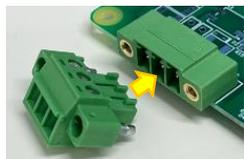
端子台部分をレセプタクルの奥までしっかりと差し込み、外れ防止のために横2つのネジをしめて固定します。ケーブルの接続は基板上のシルクを参考に (+) (-) の位置にツイストペアケーブル、(SH) にシールドを接続します。
